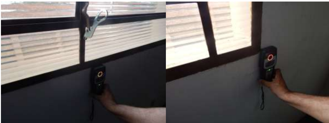
Figura 41: Ensaio não destrutivo de Pacometria
