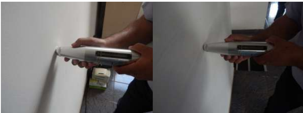
Figura 50: Ensaio não Destrutível de Esclerometria de Reflexão
