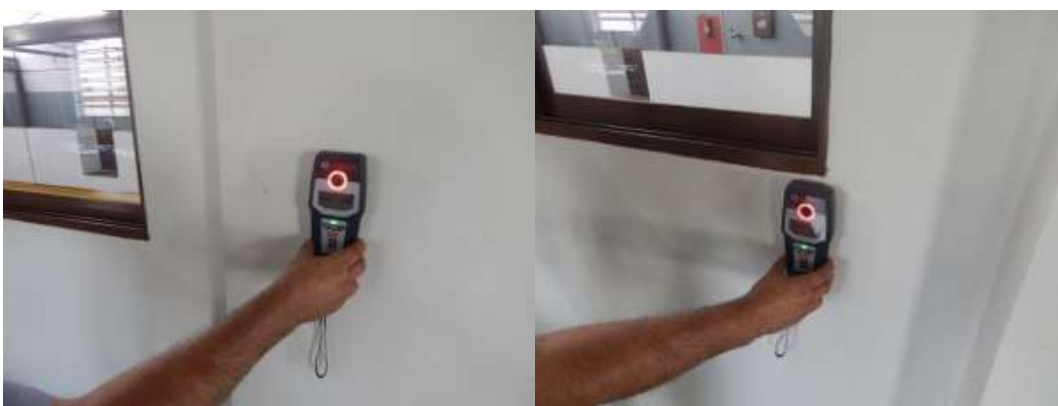
Figura 34: Ensaio não destrutivo de Pacometria
