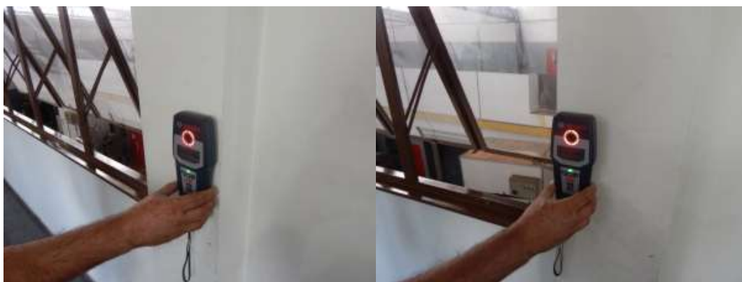
Figura 36: Ensaio não destrutivo de Pacometria
