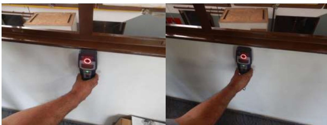
Figura 37: Ensaio não destrutivo de Pacometria
