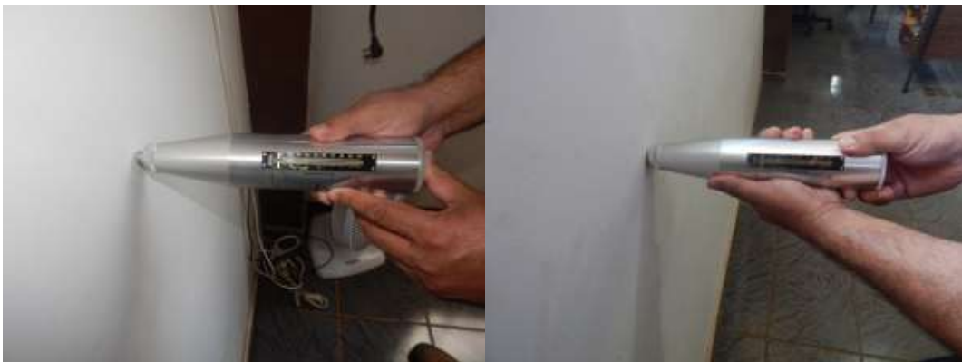
Figura 49: Ensaio não Destrutível de Esclerometria de Reflexão
