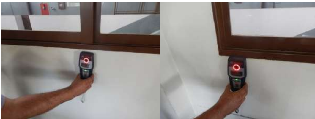
Figura 35: Ensaio não destrutivo de Pacometria
