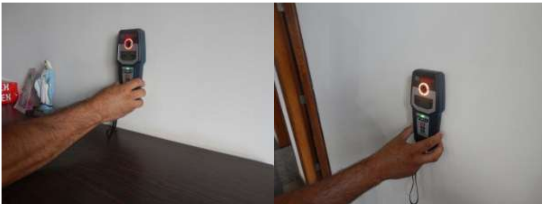
Figura 32: Ensaio não destrutivo de Pacometria
